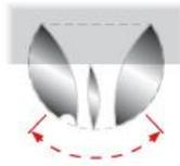
Die Luftaustrittsdüse lässt sich von Hand mittels Raster nach außen oder innen verstellen. Stellen Sie die Düse so ein, dass die Luftrichtung möglichst zur Türschwelle hin / gegen die Außenluft ausgerichtet ist.
