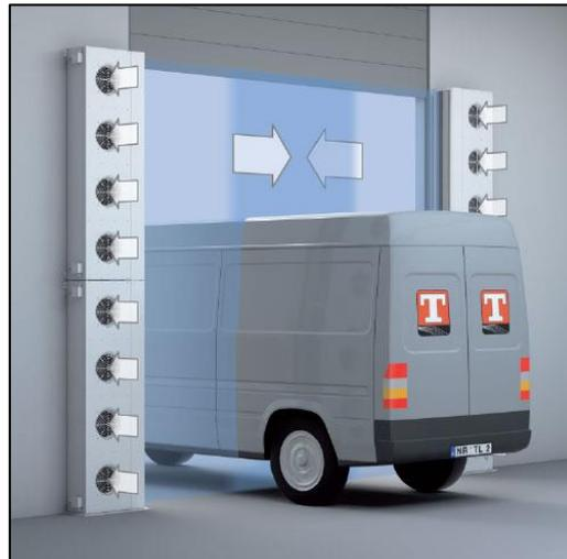
**Doppelanlage – vertikale Montage**
